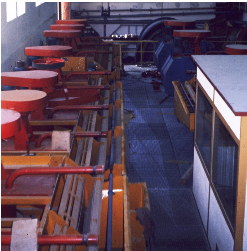
Abb. 11: Flotationsanlage Antonischacht 1970. Im Hintergrund ist die Trommelmühle erkennbar. (Quelle: Bergbaumuseum Klagenfurt, ursprünglich DI Klaus Jedlicka)
