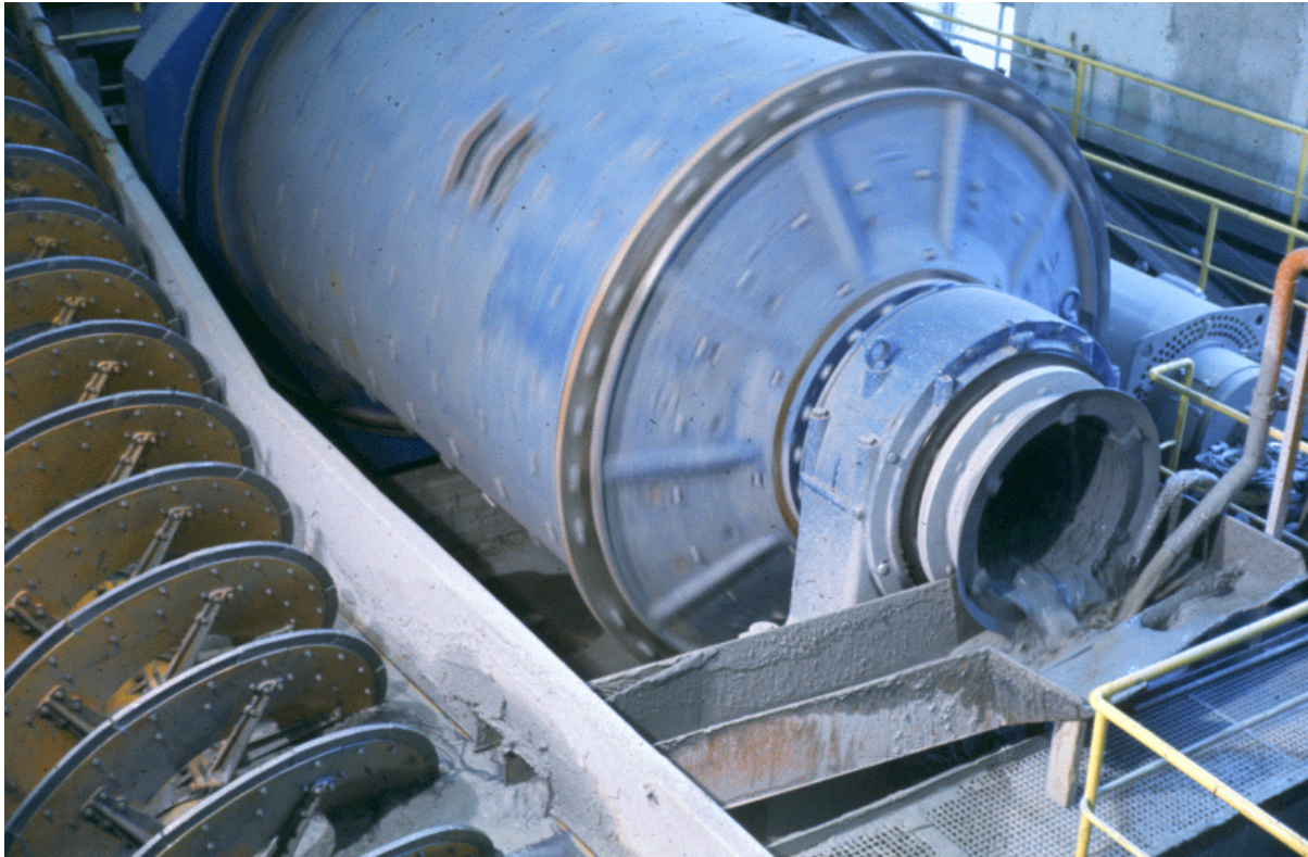
Abb. 10: Trommelmühle und Schraubenklassierer (Werksfoto)
