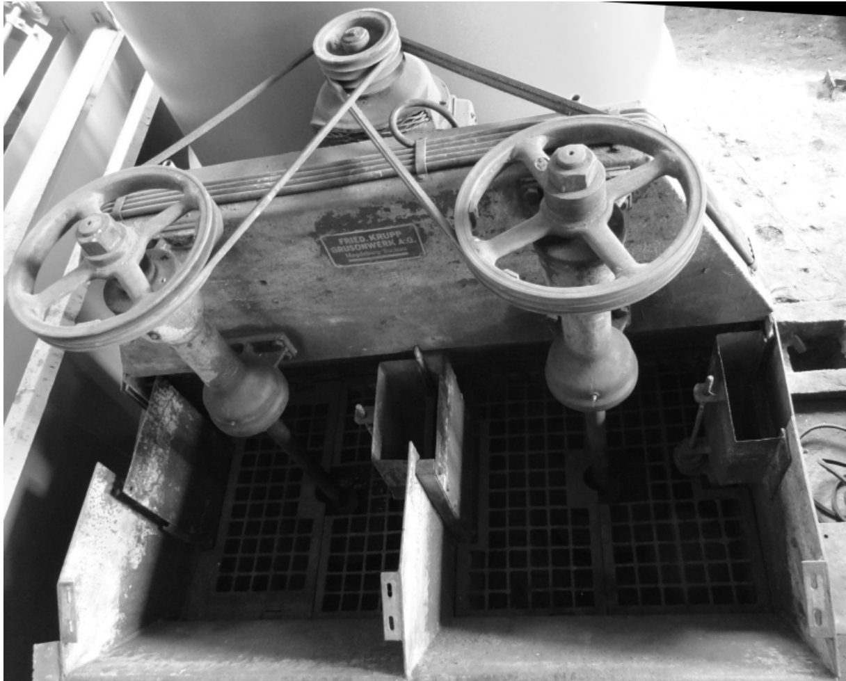
Abb. 7: Ein im Zuge des Umbaus 1939/40 eingesetzter Doppelzellen-Rührwerksflotationsapparat, Bauart „Krupp“ (Foto: 2012)
